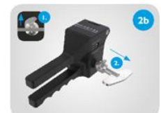
Abnehmen des Drehhebels von der Welle des Schneidzylinders. 1. Verriegelung öffnen. 2. Hebel von der Welle schieben.
