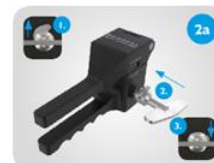
Anbringen des Drehhebels auf der Welle des Schneidzylinders. 1. Verriegelung öffnen. 2. Hebel auf der Welle bis Anschlag schieben. 3. Verriegelung schließen.
