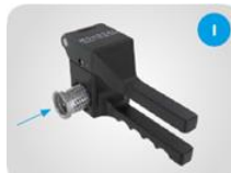
Griešanas cilindra ievietošana. Pilnībā ievietojiet griezamo cilindru.
