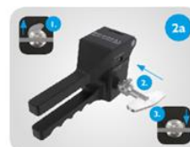
Bevestig de draaihendel aan de as van de snijcilinder. 1. Open de blokkeervoorziening. 2. Duw de hendel op de as zo ver mogelijk tot aan de aanslag. 3. Sluit de blokkeervoorziening.
