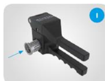
Instellen van de snijcilinder. Stel de trekcilinder volledig in.
