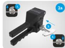
Připevnění otočné páky na hřídel rezného válce. 1. Otevřete zámek. 2. Nasuňte páku na hřídel až na doraz. 3. Uzavřete zámek.
